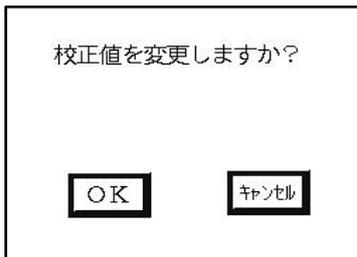
「OK」で校正モードの画面に移行し、「送りすぎ量」の設定はクリアされ、0(ゼロ)になります。
